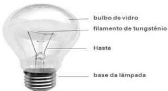
O filamento de uma lâmpada incandescente é colocado em uma câmara livre de oxigênio para evitar sua oxidação, o que levaria
